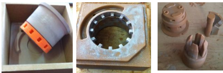
Рисунок 3 - Стержни, полученные с применением силиконовой оснастки
