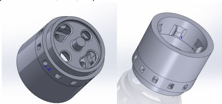
Рисунок 1 - Внешний вид отливки «Корпус», сплав АК7ч, масса 1,3 кг
